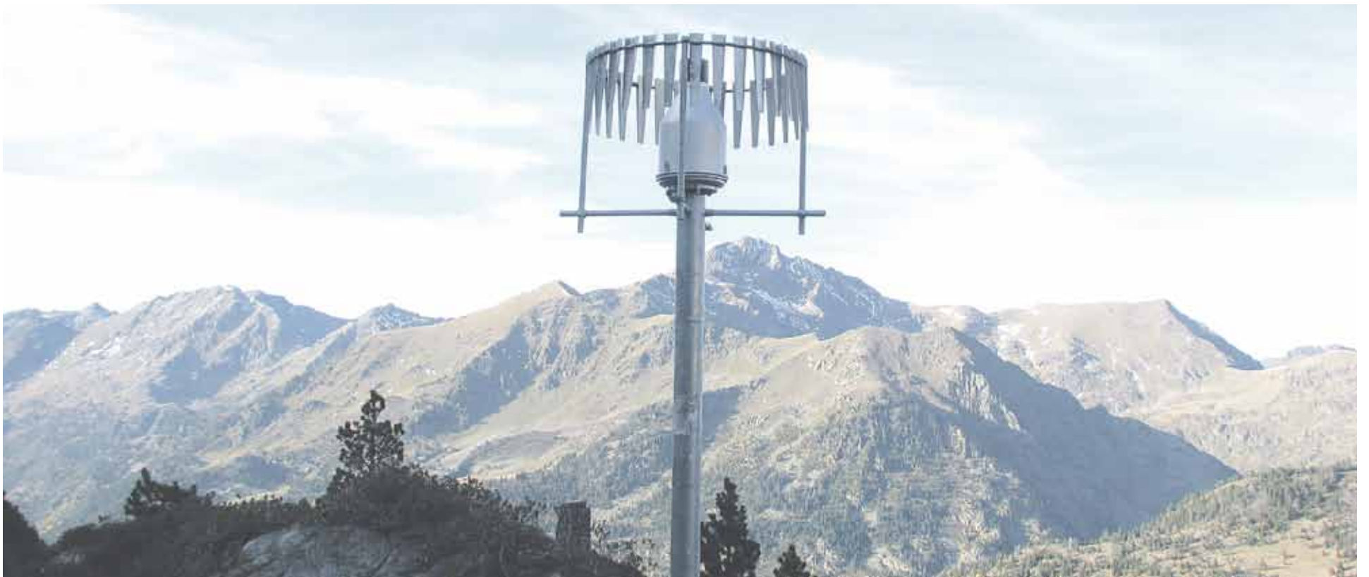
Imatge del pluviòmetre totalitzador de l'estació nivometeorològica al Parc natural de la vall de Sorteny, gestionada pel CENMA. Al fons, el pic de Font Blanca.
